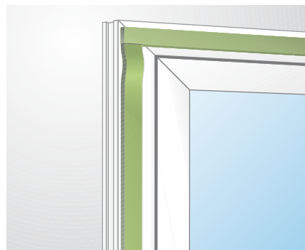
Afbeelding 1: Hoek aansluiting bij de kozijnmontage
